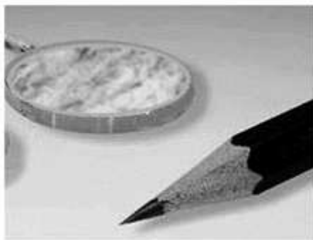
Figure 3 : exemple de capteur de force piézoélectrique prêt à être incorporé dans un circuit électrique.
