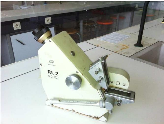
Le réfractomètre d'Abbe mesure l'angle de réfraction  $i_2$  d'un rayon lumineux qui est relié à l'angle d'incidence  $i_1$  selon les lois de Snell - Descartes. Le dioptre considéré ici est l'interface formée par la substance S dont on veut déterminer son indice de réfraction  $n_S$  et le prisme P qui a un indice de réfraction  $n_P$  élevé ( $n_P > n_S$ ).
