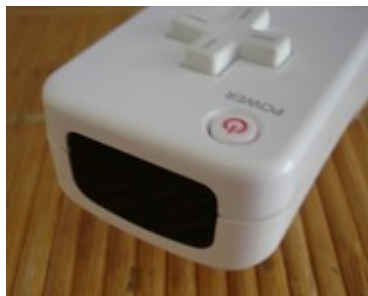
Capteur IR de Wiimote
