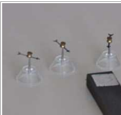
Aiguilles aimantées dans un CHAMP MAGNETIQUE B créé par un aimant droit.
