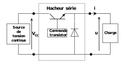
On utilisera comme source de tension l'alimentation GPR que l'on réglera à 30 V.
