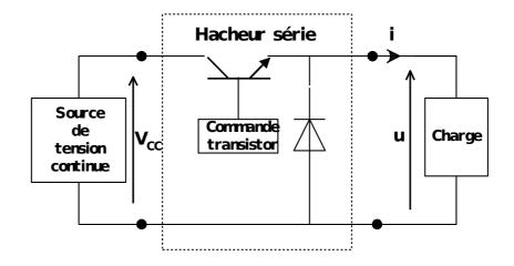
De 0 à  $^{\alpha}$  T, le transistor conduit, la diode est bloquée :
