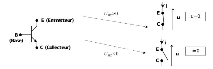
La commande (ouverture et fermeture) du transistor s'effectue entre les bornes B et C. Le transfert de puissance s'effectue entre les bornes E et C
